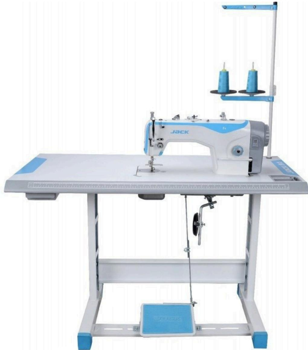
La máquina de coser industrial plana es una herramienta robusta y de alta velocidad diseñada para costura recta en materiales textiles. Es ideal para la **creación de prototipos de prendas**, ya que permite unir piezas de tela con precisión, resistencia y uniformidad. Su estructura está preparada para trabajos continuos, con motores potentes y mesas amplias que facilitan el manejo de diferentes tipos de tela, desde livianas hasta medianamente pesadas.
